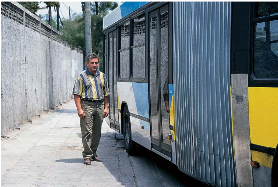
(β) Πίσω πρόβολος λεωφορείου σε στροφή.
